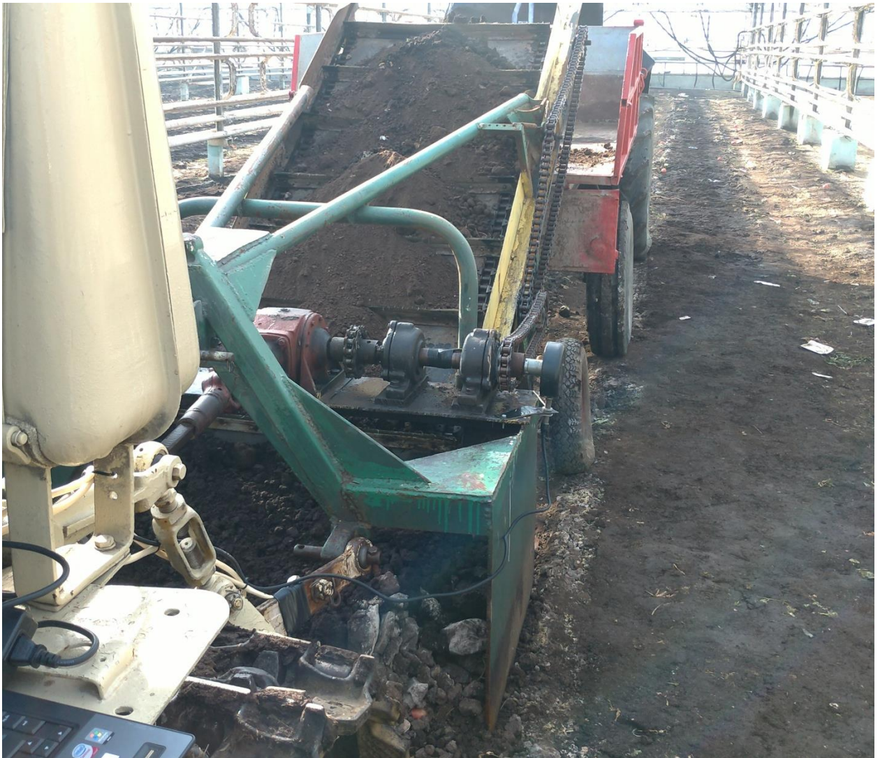
Рисунок 5.3 – Машина для удаления и погрузки тепличного грунта в работе в АО «Совхоз-Весна»
