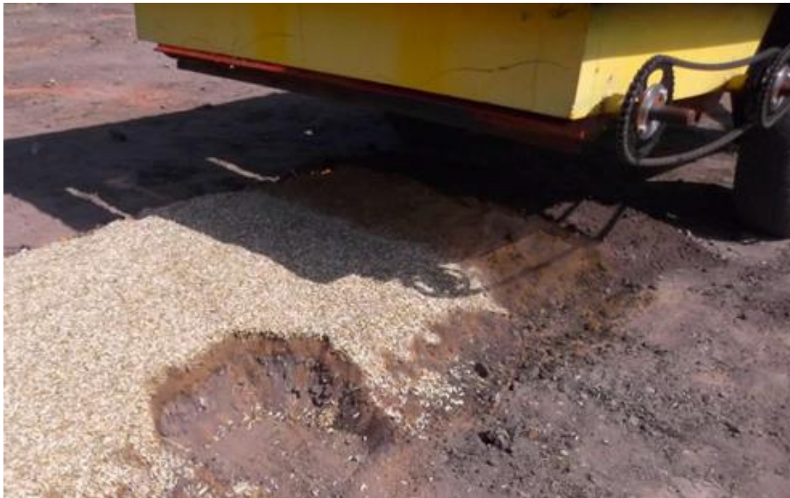
Рисунок 3.3 – Взятие проб для замеров после послойной укладки компонентов тепличного грунта
