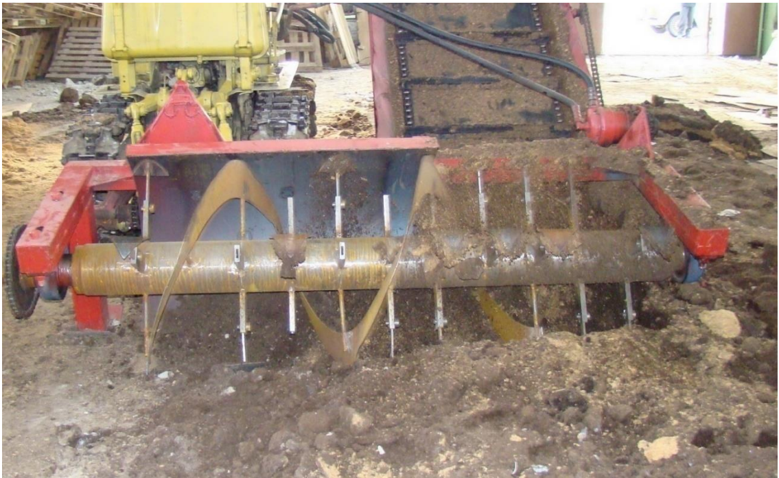
Рисунок 4.12 – Перебрасывание части компонентов тепличного грунта при большой частоте вращения шнекофрезерного рабочего органа
