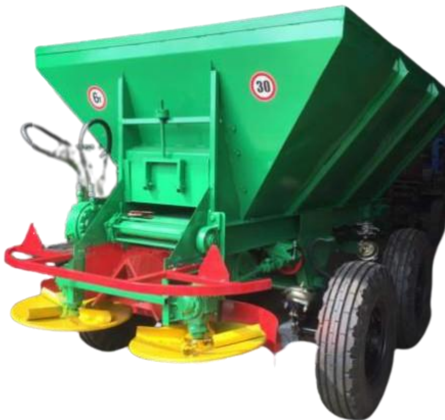
Рисунок 1.7 – Общий вид разбрасывателя РУМ-5 (МВУ-5) оснащенного двумя рассеивающими устройствами центробежного типа
