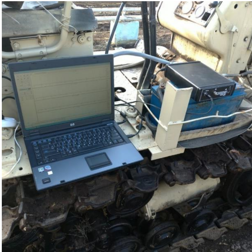
Рисунок 3.13 – Измерительный комплекс на машине для удаления грунта
