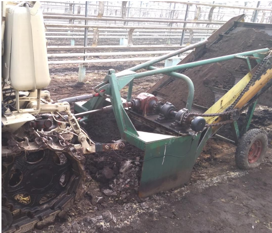
Рисунок 4.5 – Процесс взаимодействия ковша машины со слоем тепличного грунта
