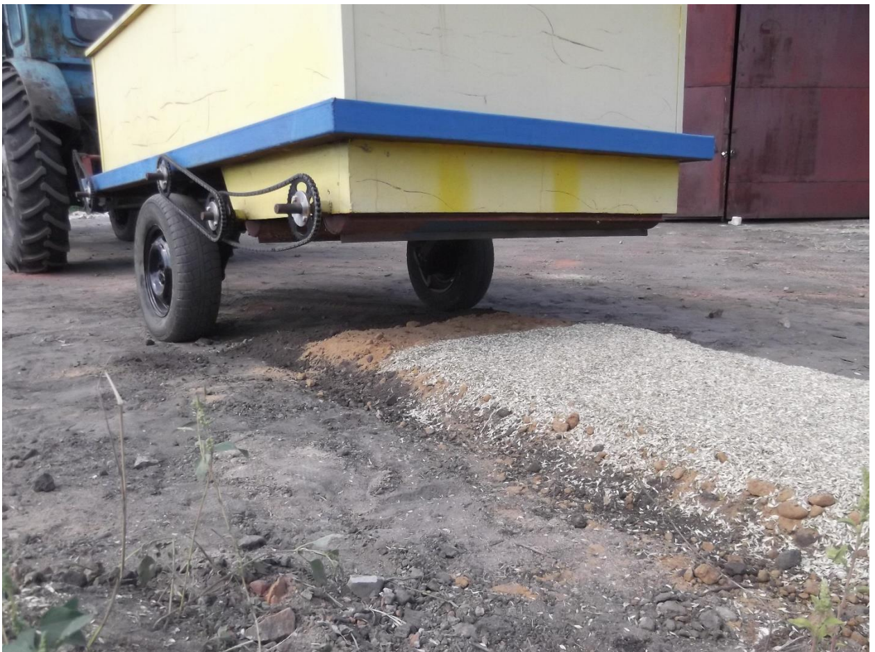
Рисунок 5.1 – Укладка компонентов тепличного грунта комбинированным укладчиком
