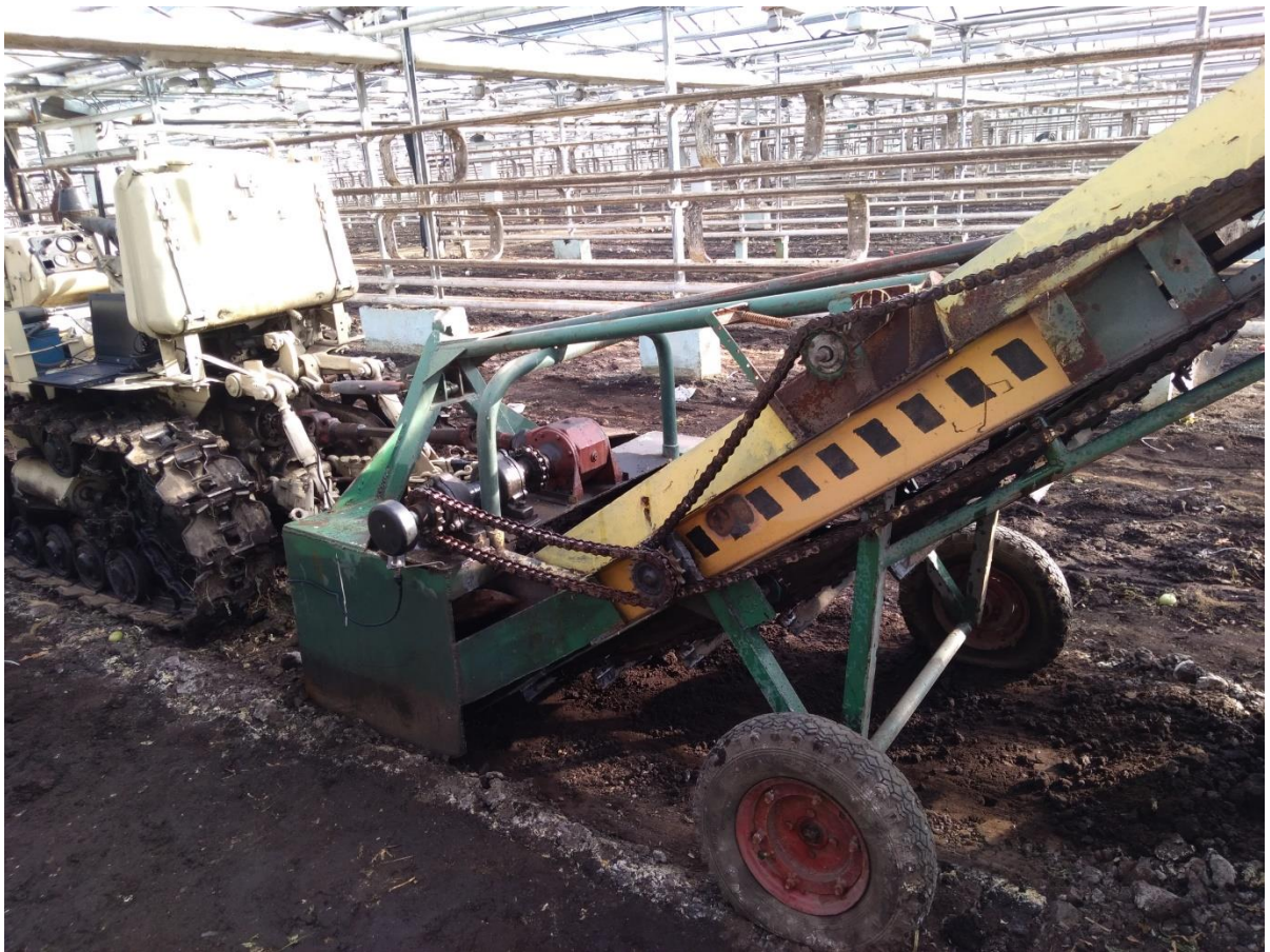
Рисунок 3.19 – Экспериментальные исследования процесса удаления и погрузки тепличного грунта
